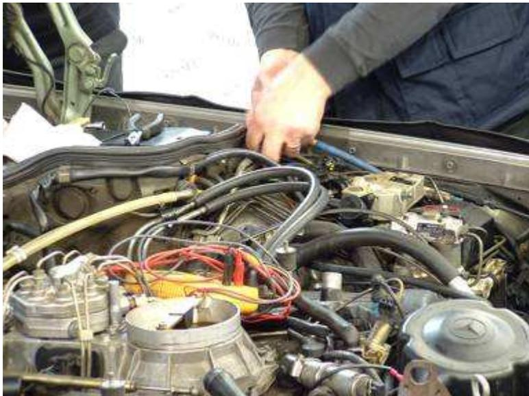
Einbau des Steuergerätes zur steuerbegünstigenden Abgasreinigung.
