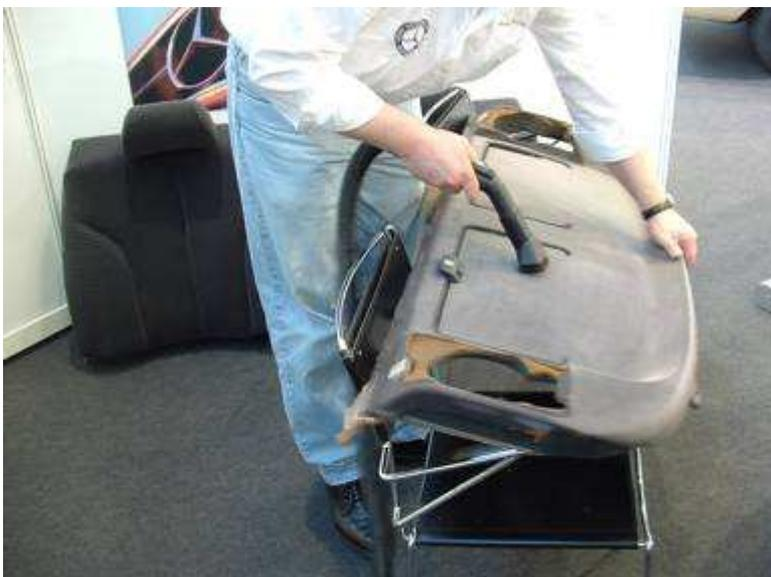
Ausbau der Rückbank und der Heckablage, ...
