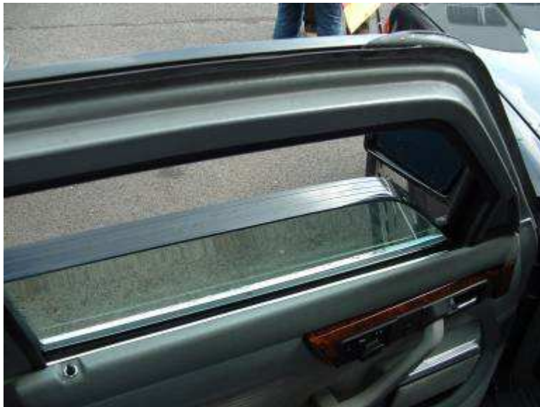
B7-Panzer mit B6-Panzerglas: Fast 3 to wiegt dieser Luxuskoloss!
