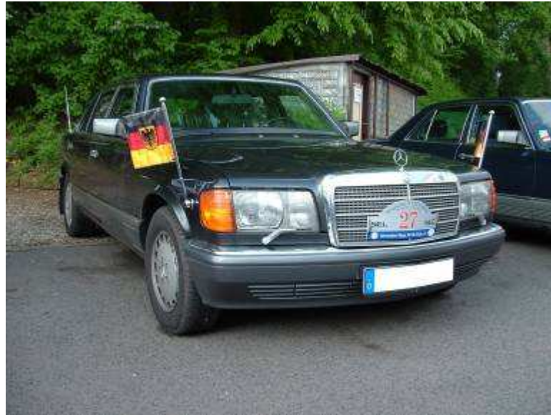
B7-Panzer mit B6-Panzerglas: Fast 3 to wiegt dieser Luxuskoloss!
