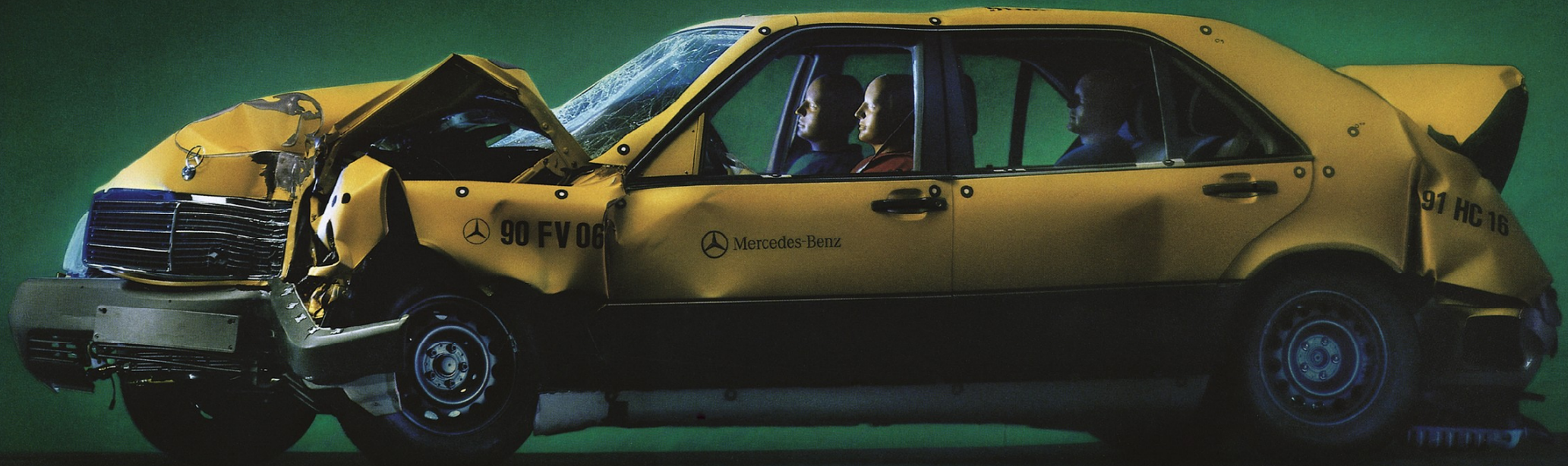
Die neue Rohbastruktur im Test.
